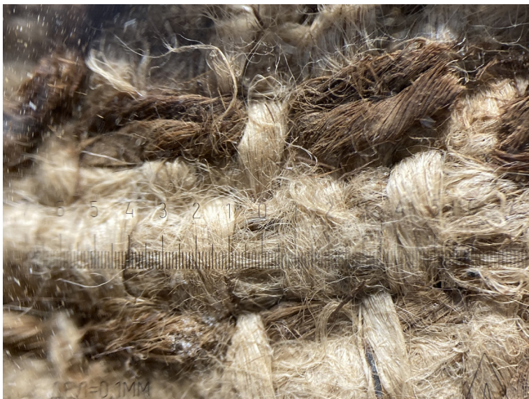
Рис. 3. № 387.0.T-003. Нити вводного утка из неокрашенного ферментированного льна © ЦЕИ РАН
