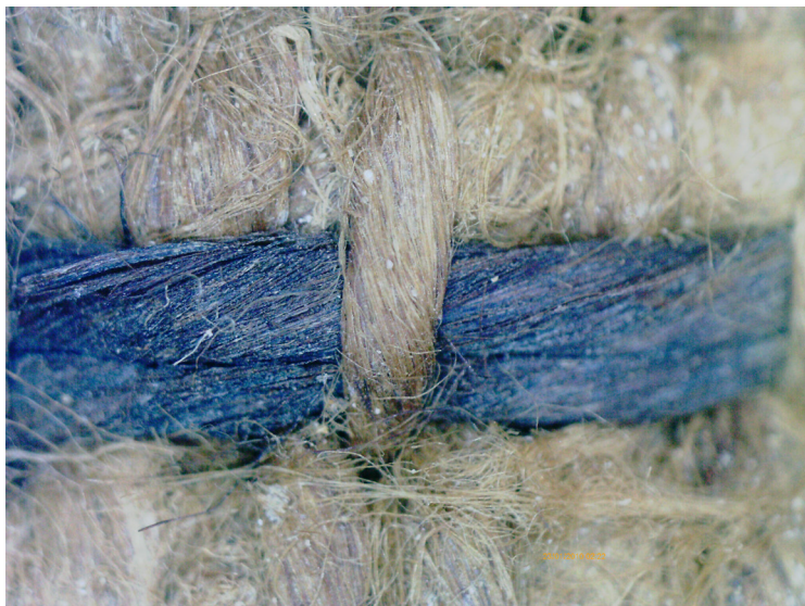
Рис. 4. № 380.0.Т-005. Нити вводного утка из льна, окрашенного минеральными пигментами © ЦЕИ РАН
