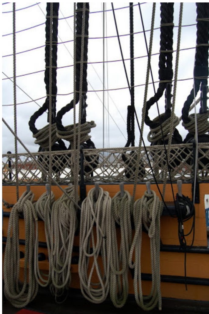
Рис. 23. Снасти на кофель-нагельной планке на борту современного парусника
